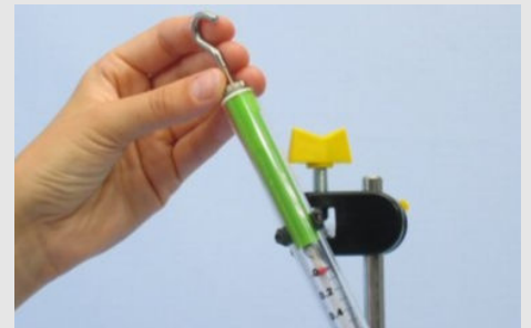
Insertar y ajustar los medidores de fuerza
