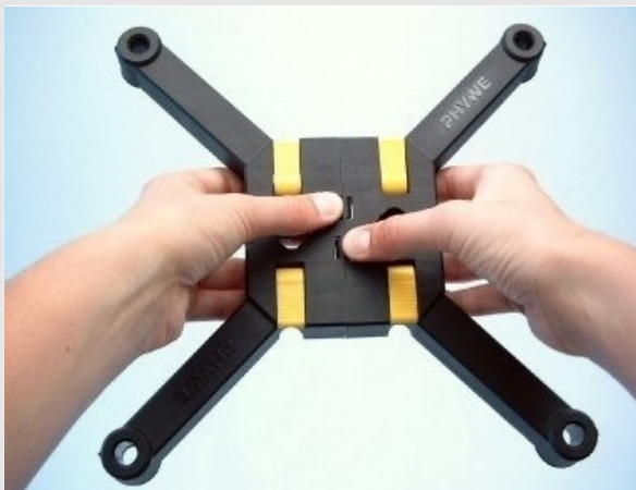
Desmontando la base del trípode
